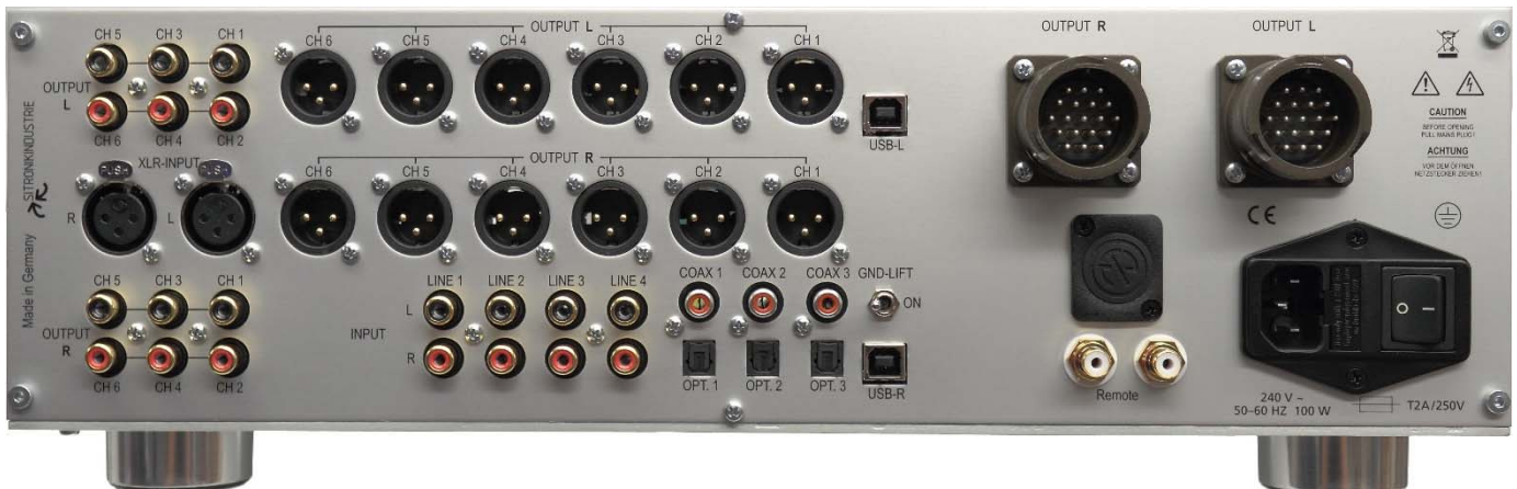
Rückseite Lucius 12K-V-3U (B = 450 mm, H = 150 mm, T = 390 mm)
